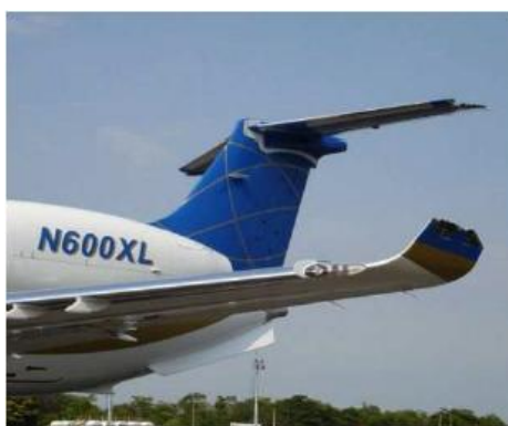
Figura 1:Winglet N600XL danificado pós acidente
