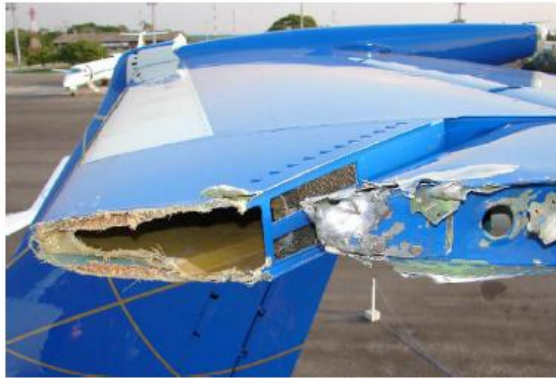
Figura 2: Profundor N600XL danificado pós acidente
